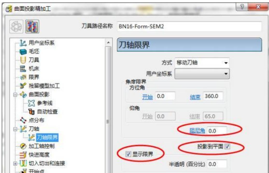
勾取投影到平面后，刀轴限界被展平，产生一 4 轴限界（在此相对世界坐标系）。减速角设置为 0 可确保完全保持 4 轴定向。
