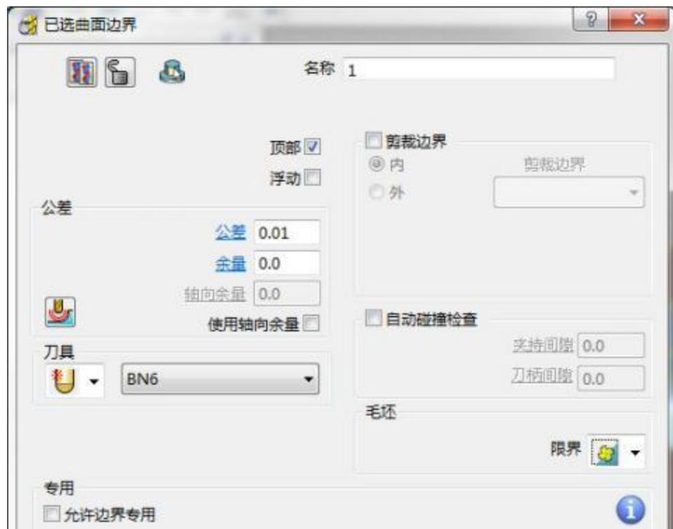
39 严格按照上图在已选曲面边界对话视窗中输入相应数据并勾取顶部方框，将限界选项设置为刀具中心限制在毛坯边缘。
