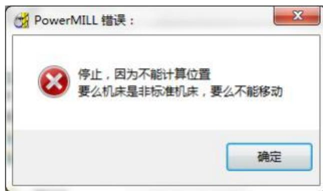
由于刀具路径为全 5 轴刀具路径 因此无法对旋转机床运行仿真。
