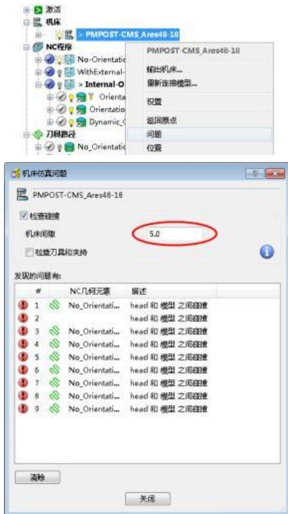
19 在对话视窗中输入适当的机床主轴间隙值。
