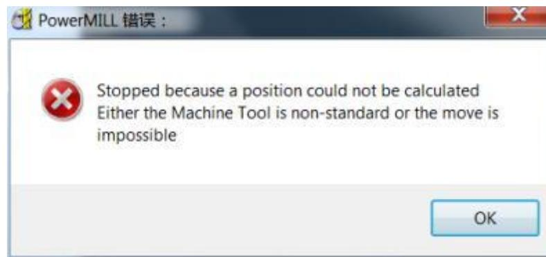
仿真刀具路径的 X 坐标超出了机床的 X 轴行程。注：行程限界包含在机床模型定义。
