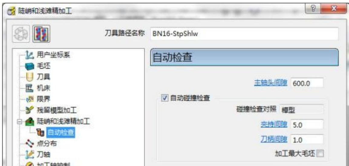
这个练习的目的是根据已有刀具路径产生两条新的刀具路径 第一条设置适当的朝向点 – 刀轴定向；第二条进一步将刀具路径限制为 4 轴路径。
