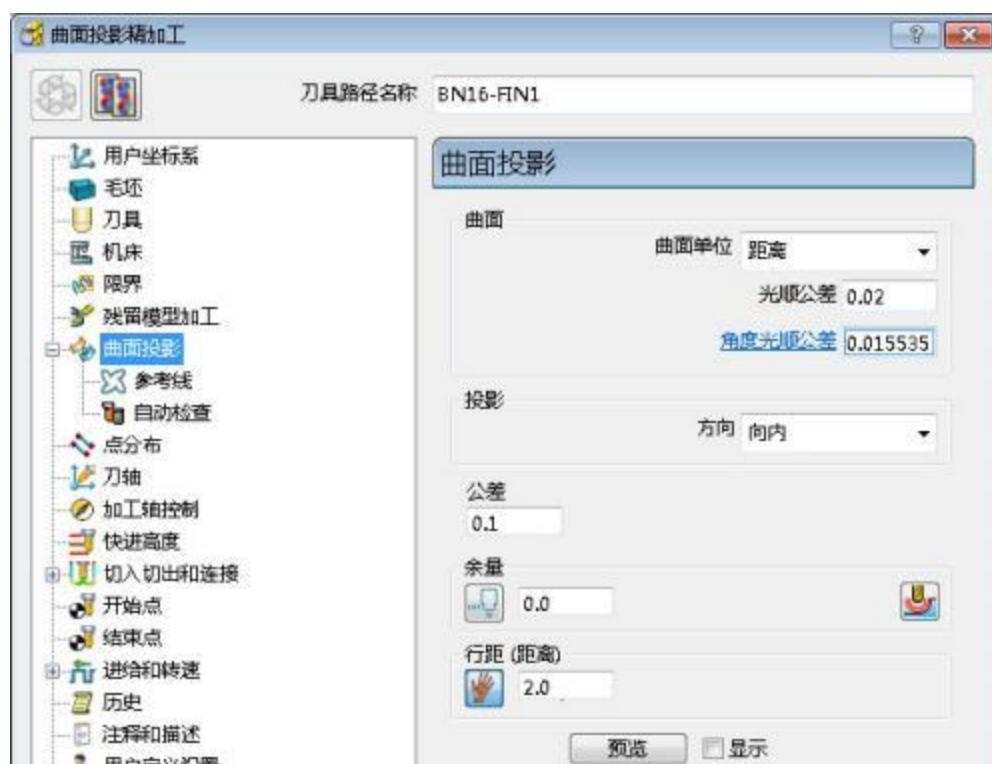
14 在曲面投影精加工对话视窗的参考线页严格按照下图输入相应值。
