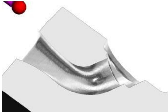
如果设置提刀高度为 0，那么就在第二端运行的刀具路径上不会存在可见的台阶。但这样也很容易导致该刀具路径在机床上运行时，刀具掘进到此区域。
