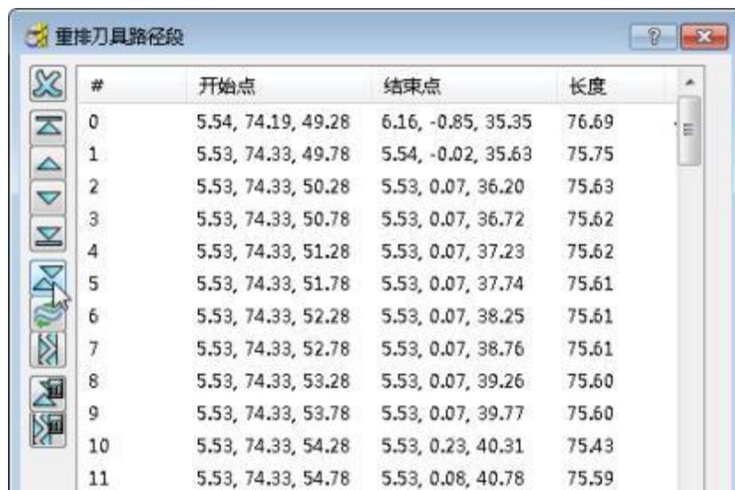
10 在重排刀具路径段对话视窗中选取反转顺序。
