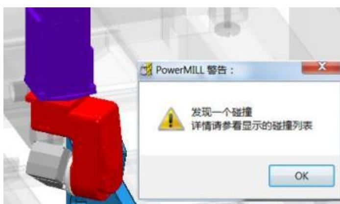
几条路径后，机床的主轴就和部件出现碰撞。发现碰撞后，PowerMILL 警告方框随即出现在屏幕，机床主轴变为红色。
