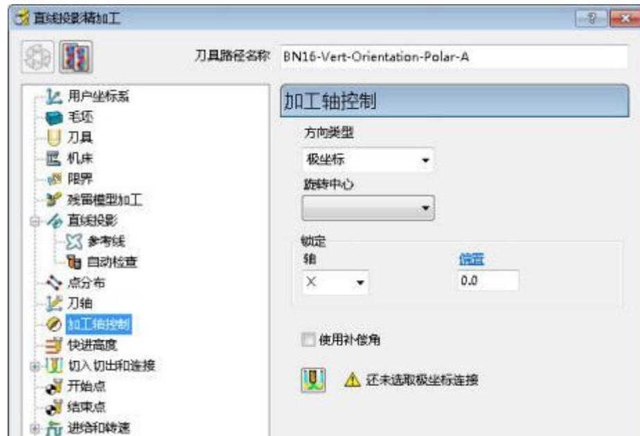
14 点击 ，按照下图改变连接页并输入相关值，同时勾取使用极坐标连接。
