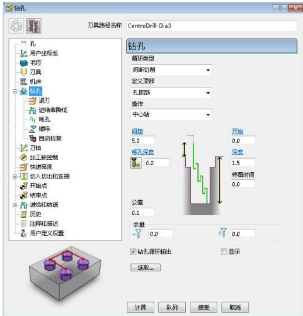
17 回到主钻孔页，点击计算，产生中心钻刀具路径，然后取消对话视窗。
