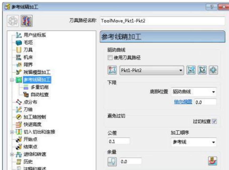
18 选取表格中的刀轴页面，然后输入刀轴 - 前倾/侧倾，侧倾角度为 45，方式 - 垂直。
