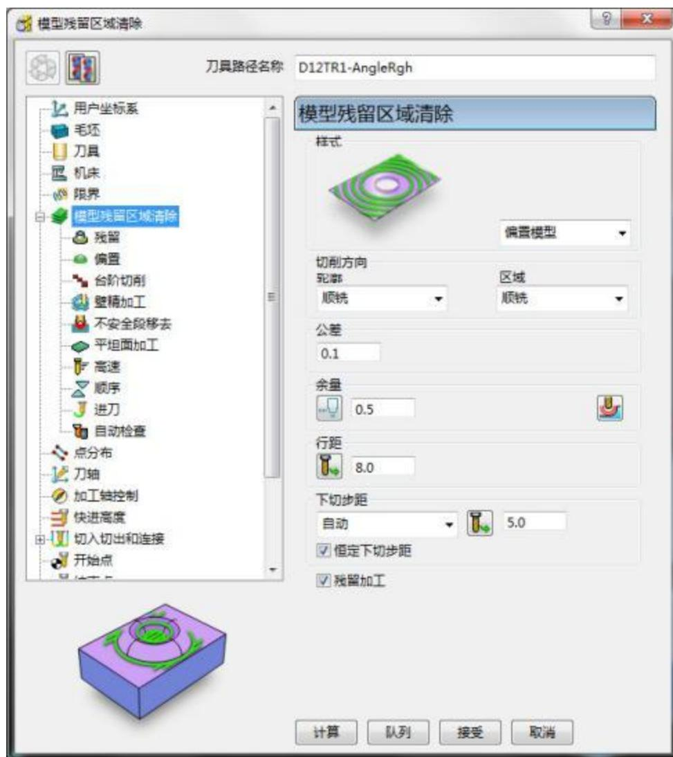
27 在对话视窗的本地浏览器中选取残留页面，输入残留加工 – 刀具路径 - D16t3-TopRuf。
