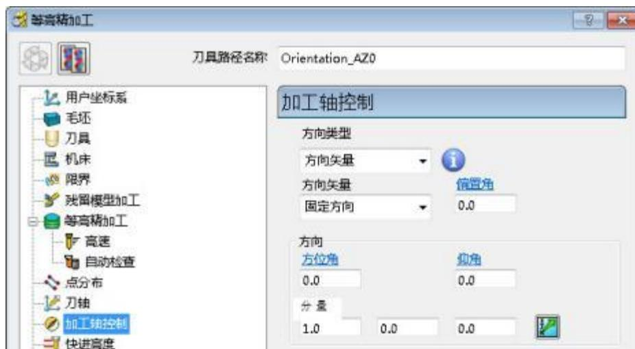
于是加工轴控制将对方向矢量使用缺省的方向矢量值：方位角 0，仰角 0。23 点击计算，产生新的刀具路径，关闭对话视窗。
