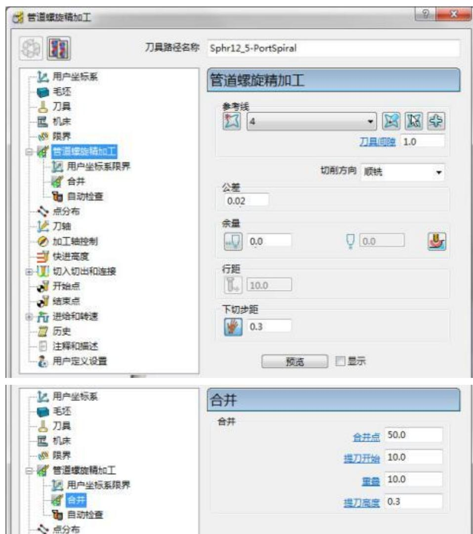
上面的合并设置使管道加工过程中，随着和第一端加工区域的合并，从第二端余量逐渐增加到 0.3 。这样做是为了补偿由于刀具切入模型后的负荷降低。
