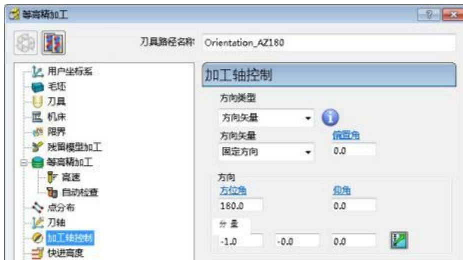
通过将缺省的方向类型由自由改变为方向矢量，主轴方向现在可直接在策略内控制。和原始刀具路径相比，加工轴控制使主轴绕 Z 轴旋转了 180 度。
