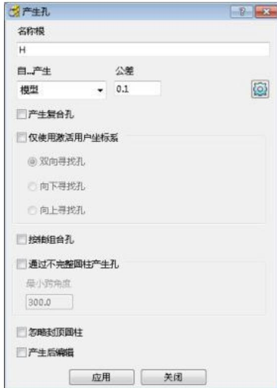
必须不勾取按轴组合孔选项，以产生多轴孔>特征设置（包括处于不同方向孔在内的全部已选孔将输入到一单个特征设置中）。
